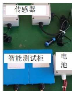
图 2 1612A 多功能数据采集器实际运行结构
