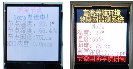
(a) 传感器节点所显示的数据 (b) 网关节点所显示的数据
