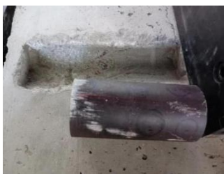
图2 灰岩与混凝土底座试件
