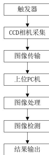
图2 车轮踏面损伤检测系统结构
