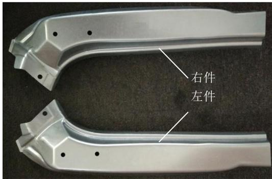
图 6 轿车 D 柱外板加强板产品
