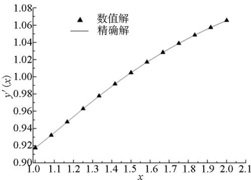
图 2 微分方程待求函数  $y'(x)$  的数值解与精确解对比
