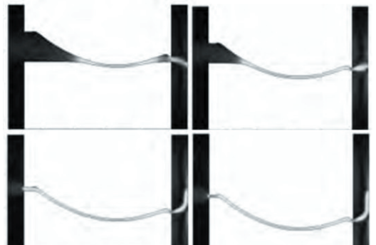
图3 COMSOL叶片电化学加工仿真示例
