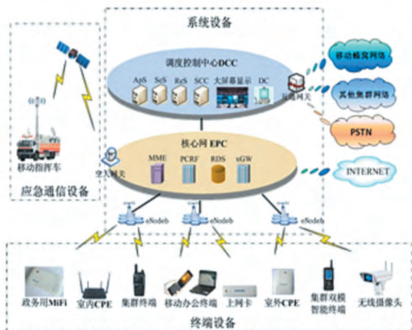
图 3 4G 宽带多媒体集群通信系统组网拓扑 该系统组网的特点是：
