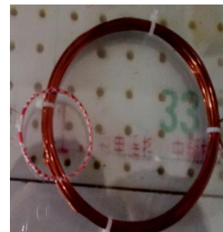
图2 能量发送和接收线圈
