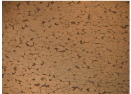
图1 耐候钢带钢横截面组织400×3%硝酸酒精溶液侵蚀
