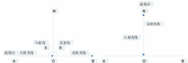
图4 入射光线和反射光线、入射角和反射角的研究图
