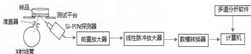
图 1 能量色散 X 荧光分析仪结构连接框图
