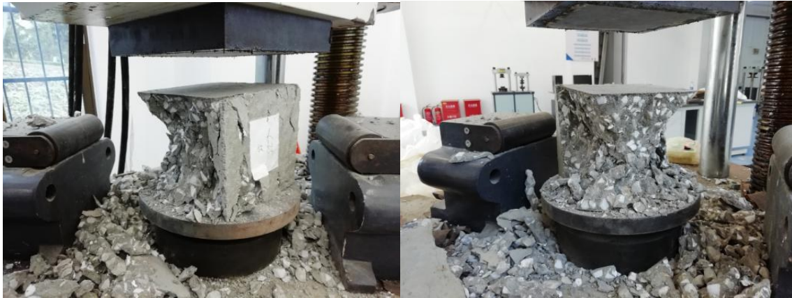
图2 海蛎壳替代率为5%的C25混凝土破坏形态(左为浇筑面,右为侧面)
