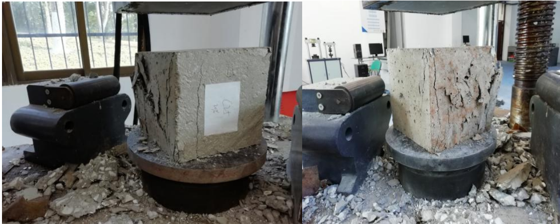
图5 海蛎壳替代率为20%的C25混凝土破坏形态(左为浇筑面,右为侧面)
