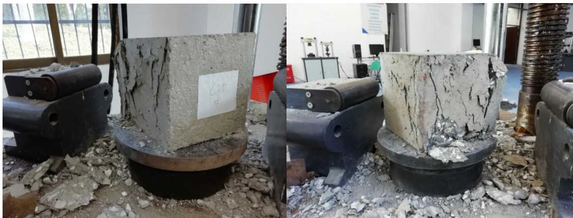
图4 海蛎壳替代率为15%的C25混凝土破坏形态(左为浇筑面,右为侧面)
