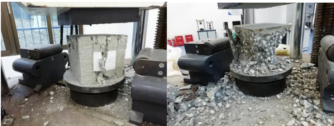
图1 C25天然砂混凝土破坏形态(左为浇筑面,右为侧面)
