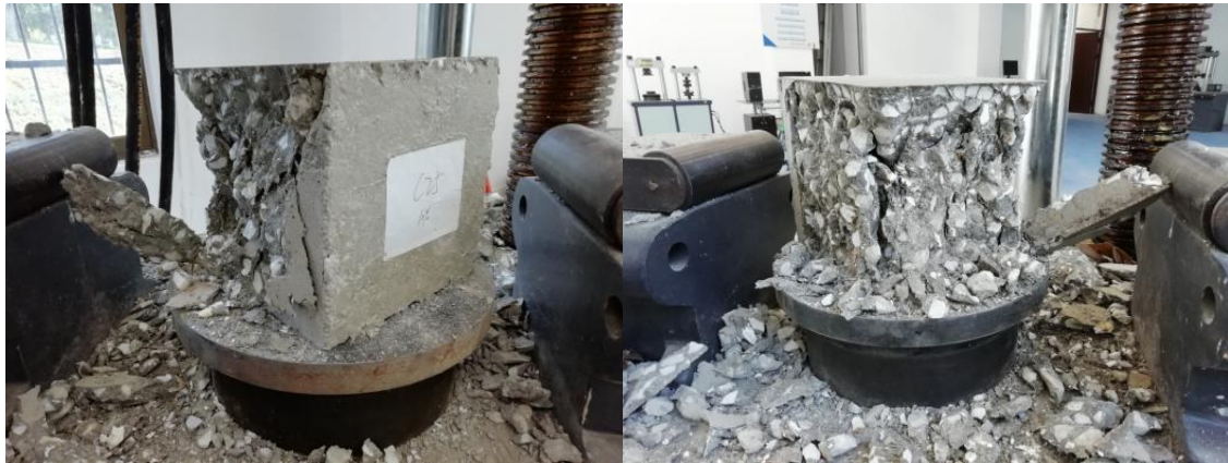
图3 海蛎壳替代率为10%的C25混凝土破坏形态(左为浇筑面,右为侧面)
