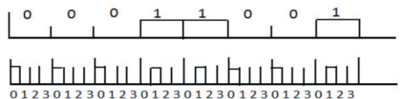
图1 PPM调制解调原理
