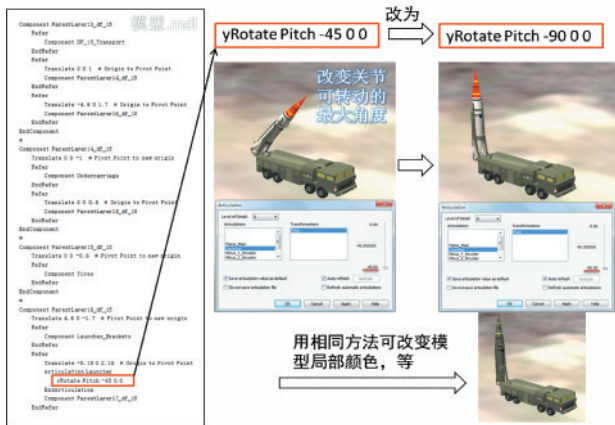
图 5 直接编辑 .mdl 文件修改模型参数
