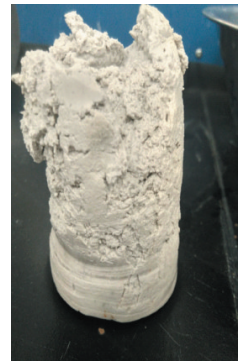
图2 非超临界条件下反应后的试样
