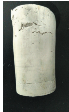
图1 超临界条件下反应后的试样
