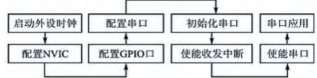
图7 STM42F372RC的串口使用流程图
