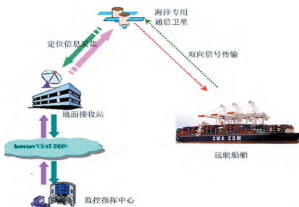
图1 在线监控系统总体结构图设计
