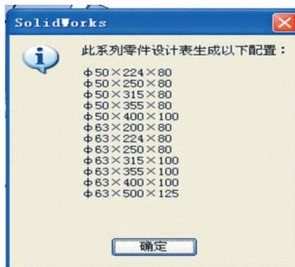
图8 有肩导柱零件生成的配置
